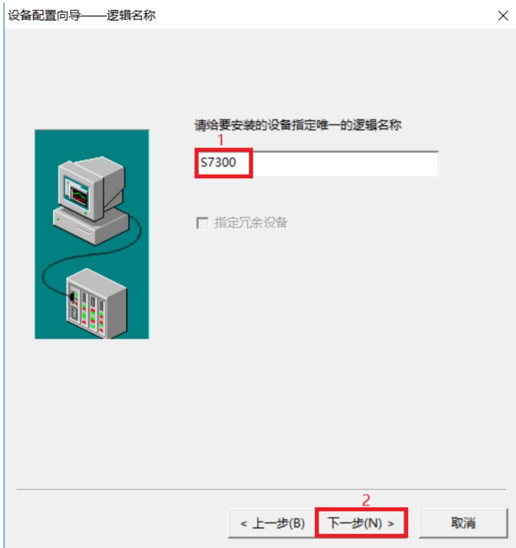
输入 S7-300 协议转换网关的地址，格式为【IP 地址：CPU 机架号：CPU 槽号】，默认为 192.168.1.188:0: 2，点击【下一步】按钮；
